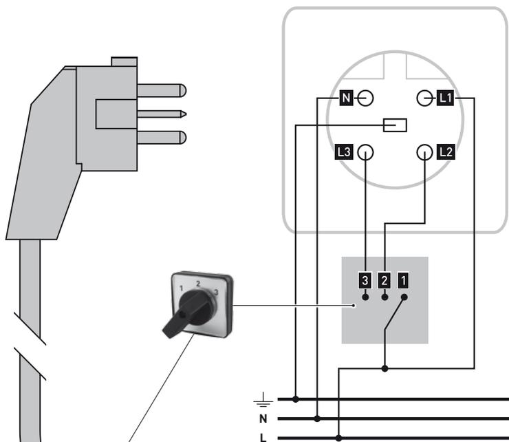
**nl** 3-standenschakelaar niet mogelijk in combinatie met **DucoBox Focus** (L2 en L3 niet beschikbaar)
