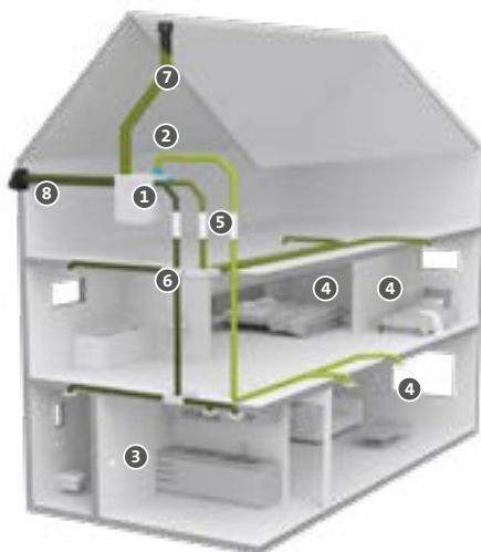
Overzicht ventilatie systeem HRC-EcoSmart/SmartComfort
